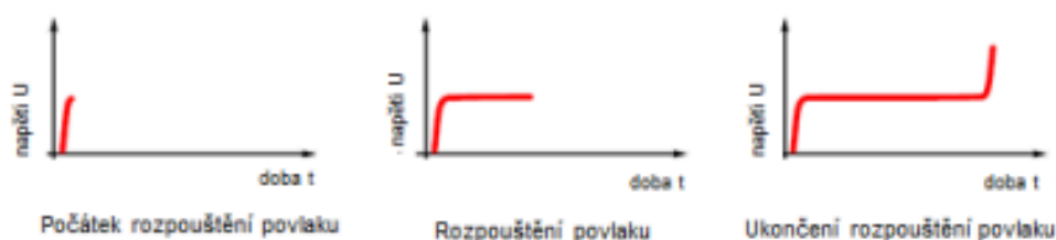
Obrázek 3 – Průběh potenciálu při měření (rozpouštění povlaku)
