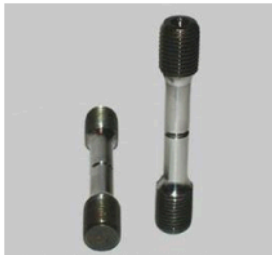
Obr. 3b: Vzhled zkušebních vzorků s definovaným zářezem
