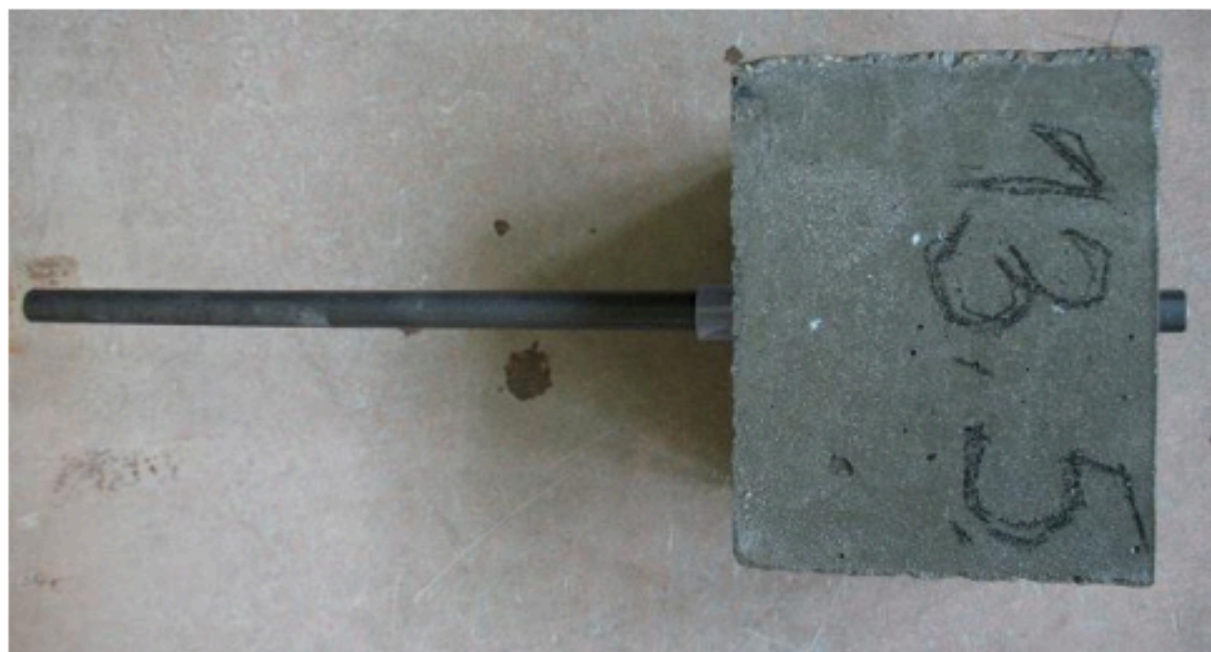
Obrázek 3. Zobrazení reálného krychlového zkušebního tělesa s hladkou „výztuží“ určeného ke zkoušce soudržnosti „vytahováním“
