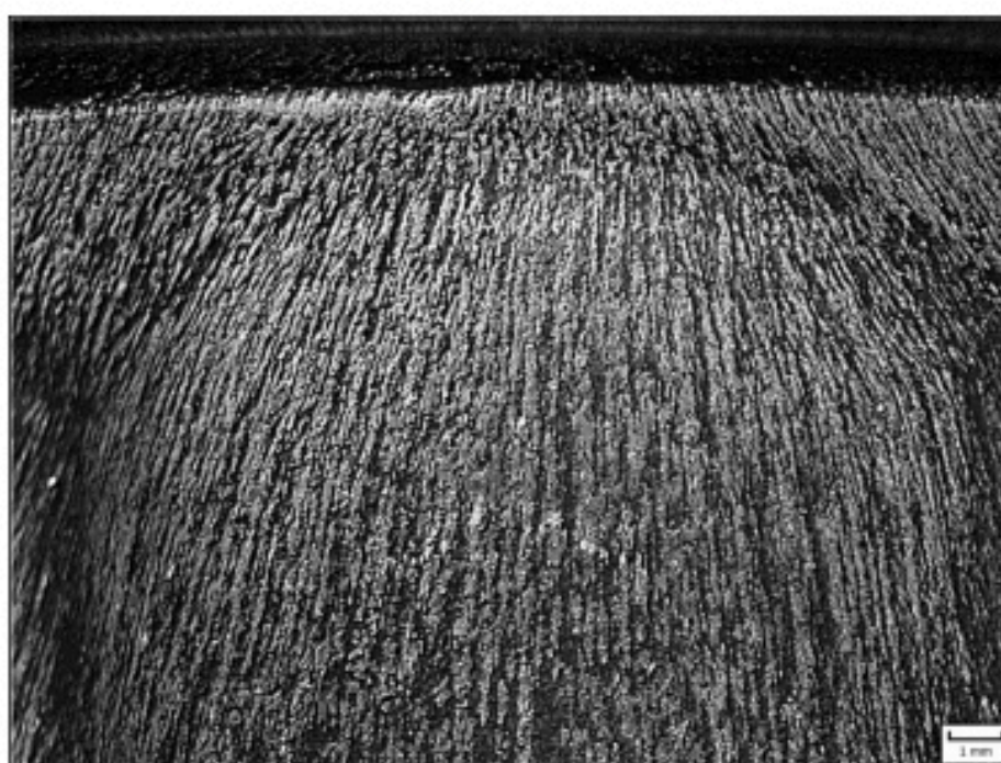
Obr. 2 Povrch mořeného výkovku v poz. 1 na obr. 1 (zvětšení 3,5x)
