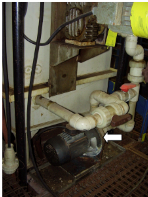
Obr. 4: Dvoupólový dotyk – zkrat se skrytým prvním dotykem přes pohon katodové tyče
