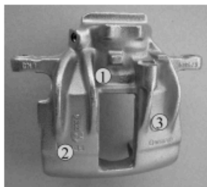
Obr. 3: Pokovení litinového dílu ve slabě kyselé slitinové lázni zinek nikl
