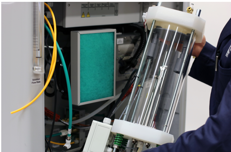
Obr. 5. Transparentní zvlhčovač vzduchu korozních komor Q-FOG
