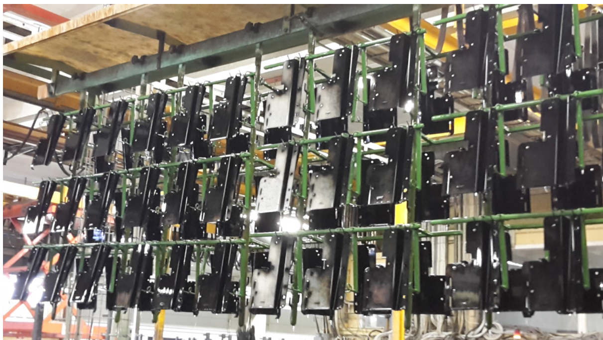
Obr. 20: Nehomogenní vznik pasivační vrstvy vlivem nehomogenního pohybu roztoku pasivace
