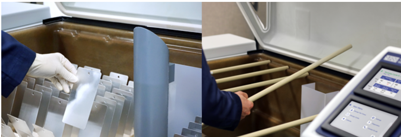
Obr. 4. Možnost umístění vzorků do korozní komory Q-FOG
