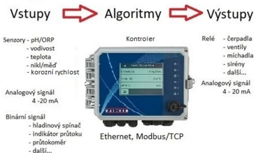
Obr. 1 vstupy a výstupy kontroleru
