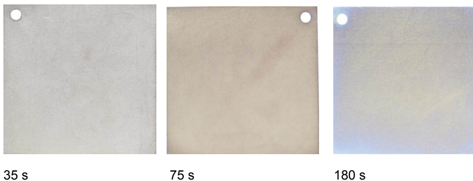
Obr. 12: Vliv doby ponoření při konstantní teplotě a hodnotě pH
