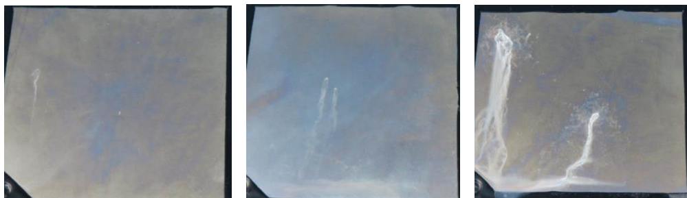
Obr. 15: Vliv kovových nečistot na ochranu proti korozi, 192 h ISO 9227
