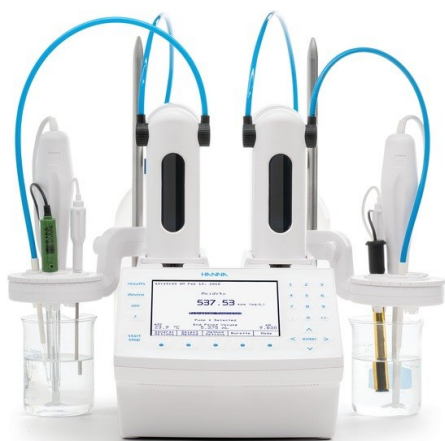
Obr. 2: Automatický titrátor model HI932 v rozšířené verzi o dvě analogové desky
