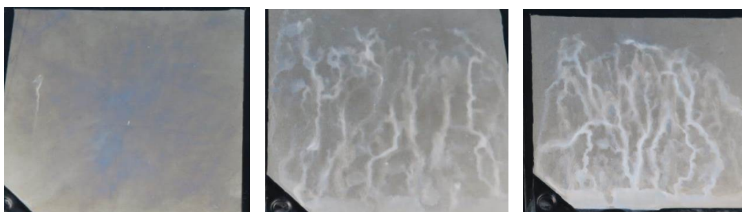
Obr. 15: Vliv kovových nečistot na ochranu proti korozi, 192 h ISO 9227
