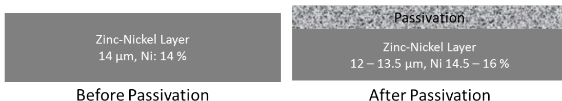
Obr. 9: Zvýšení koncentrace niklu ve vrstvě a snížení tloušťky vrstvy během pasivace
